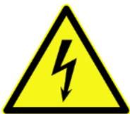
Ist die Glasröhre der Blitzröhre defekt, können die Elektroden der Blitzröhre freiliegen und es kann bei Berührung zu einem Stromschlag kommen.
