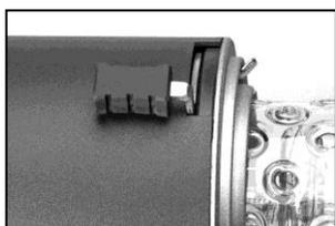
Zum Befestigen von Reflektoren oder Softboxen am Blitzkopf werden zunächst die Haltekralen der **Reflektor-Schnellwechsel-Mechanik** in die geöffnete Position gebracht. Dazu den Hebel **4** seitlich gegen die Federkraft bis zum Anschlag drücken. Jetzt das Zubehörteil plan und bündig an das Gerät ansetzen; dabei nicht verkanten. Anschließend den Hebel **4** zum Verriegeln in Richtung der Federkraft in die Ausgangsposition zurückdrücken.
