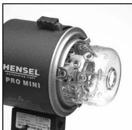
Die Schutzglocke wird an den drei vormontierten Federn befestigt. Dabei die Glocke zunächst leicht verkanten und in eine der drei Federn einsetzen. Dann die Glocke mit leichtem Druck in die anderen zwei Federn hineindrücken, bis sie sicher eingerastet ist.
