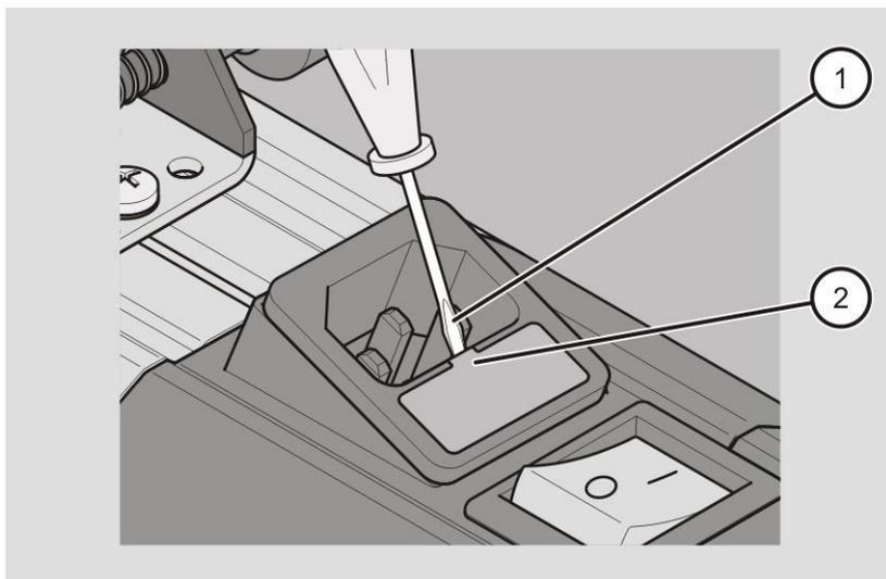
Le tiroir à fusible (1) contient deux fusibles : le fusible grillé (2) et le fusible de rechange (3).
