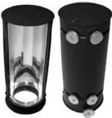
Zur Befestigung am Blitzkopf die unterste der 5 Schrauben lösen, den Reflektor über die Blitzröhre mit Glasglocke ziehen und mittels der gelösten Schraube wieder festschrauben.
